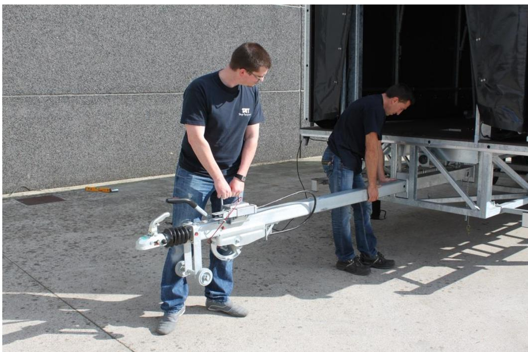
Le timon est pourvu de roulettes permettant une manipulation aisée.
