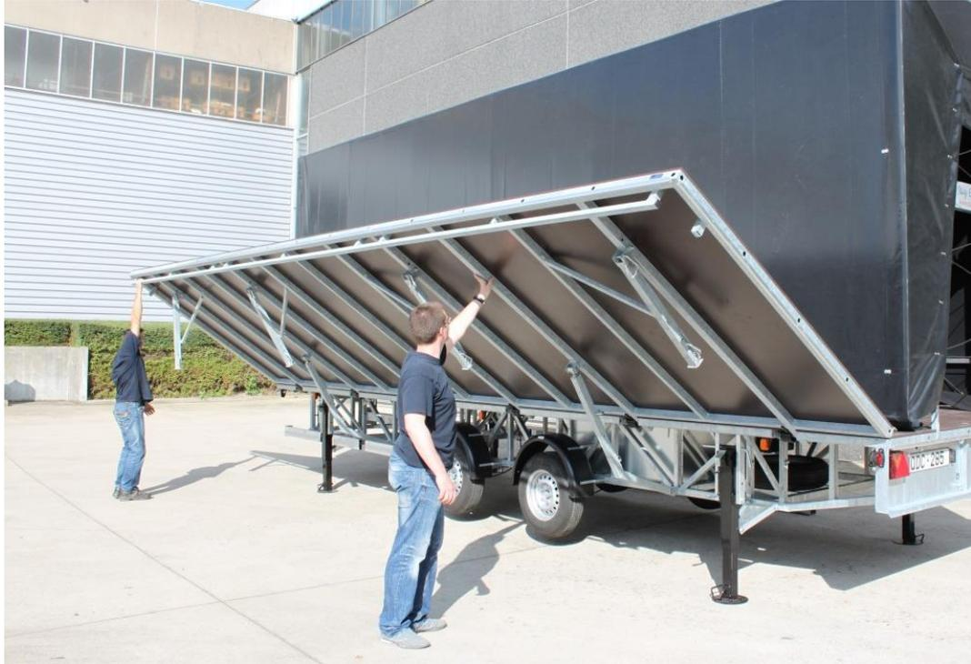
Baisser l'abattant lentement jusqu'à ce que la position horizontale soit atteinte et que le plancher soit verrouillé. Grâce aux verrous à ressort situés sur les bras antirenversement, le plancher est automatiquement immobilisé en position horizontale.
