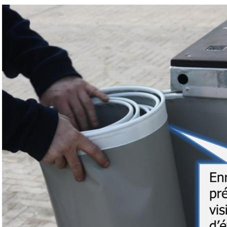
Enrouler les jupes de préférence avec la face visible vers l'intérieur afin d'éviter les souillures.
