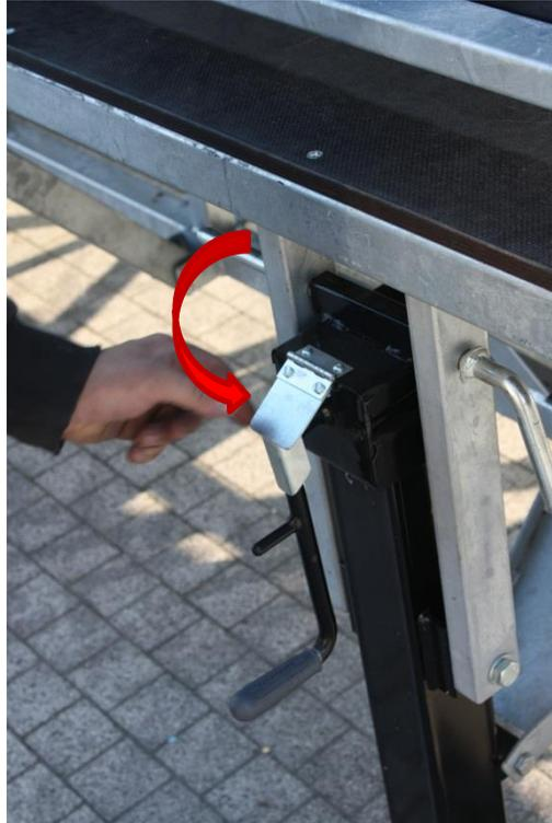
Afin d'éviter que la manivelle tourne lors du relevage de la béquille ou lors du transport un clapet rabattable immobilise celle-ci.
