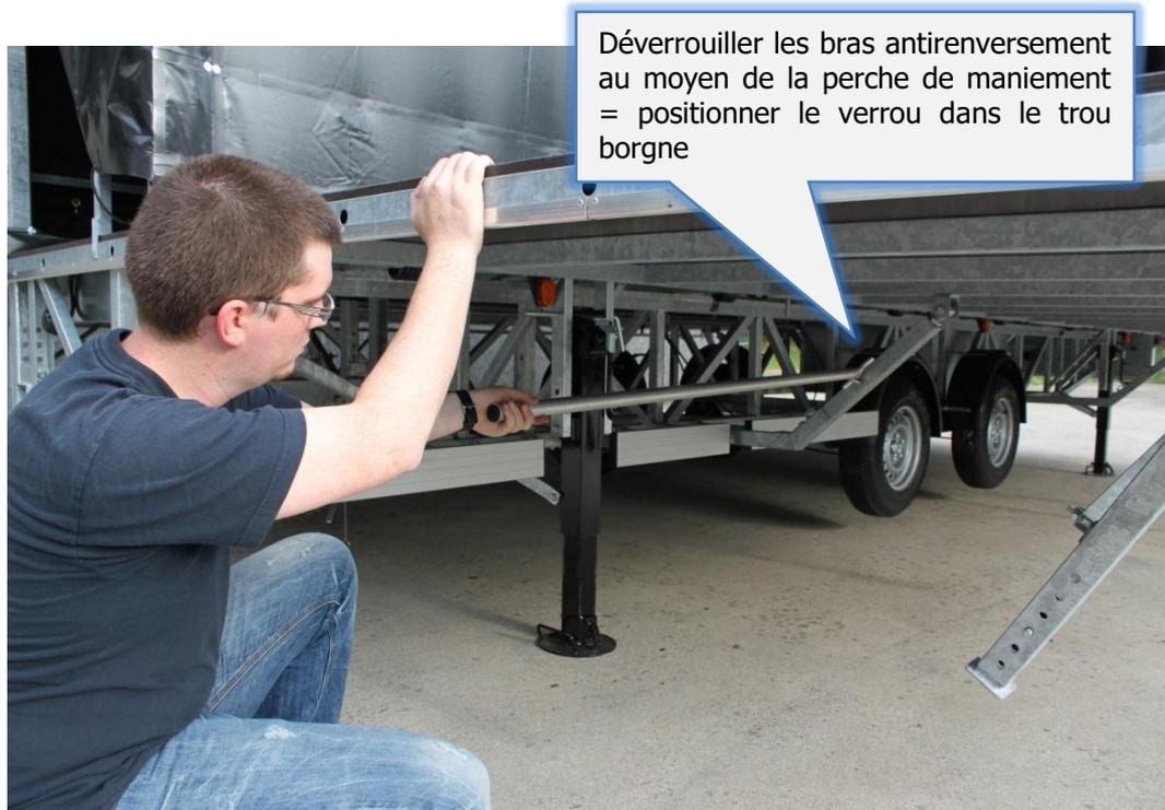
Les verrous à ressort situés sur les bras antirenversement sont retirés et positionnés dans le trou borgne. Cette opération peut également être effectuée au moyen de la perche de manègement depuis l'extrémité du plancher sans devoir accéder sous celui-ci.
