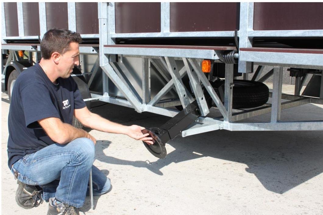
En exerçant une poussée horizontale sur la plaque d'appui, la béquille se relève et peut être bloquée en passant la broche par le dessous.
