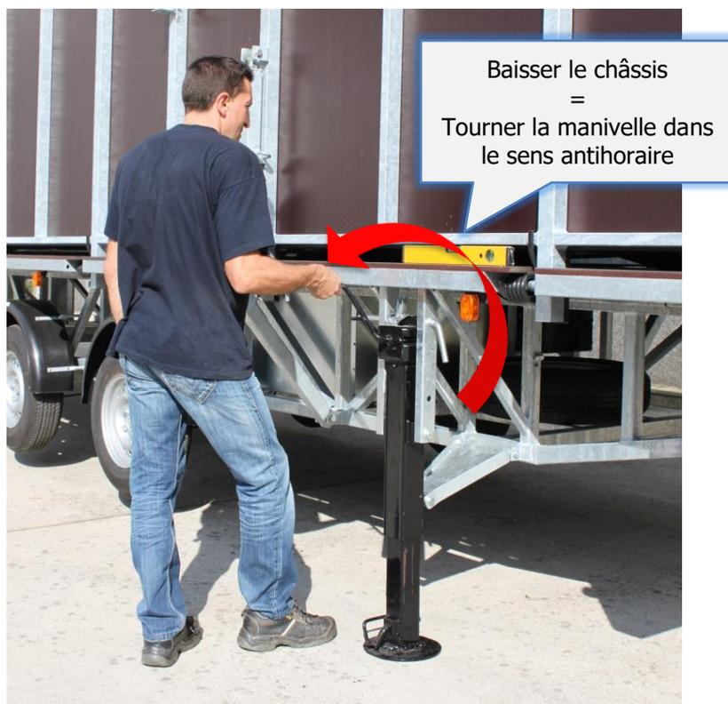
Lorsque la partie télescopique est rentrée, la manivelle est stoppée par une butée. Tourner la manivelle à nouveau dans le sens horaire jusqu'à ce qu'elle soit en position verticale vers le bas, dès lors la béquille peut être relevée dans le châssis.
