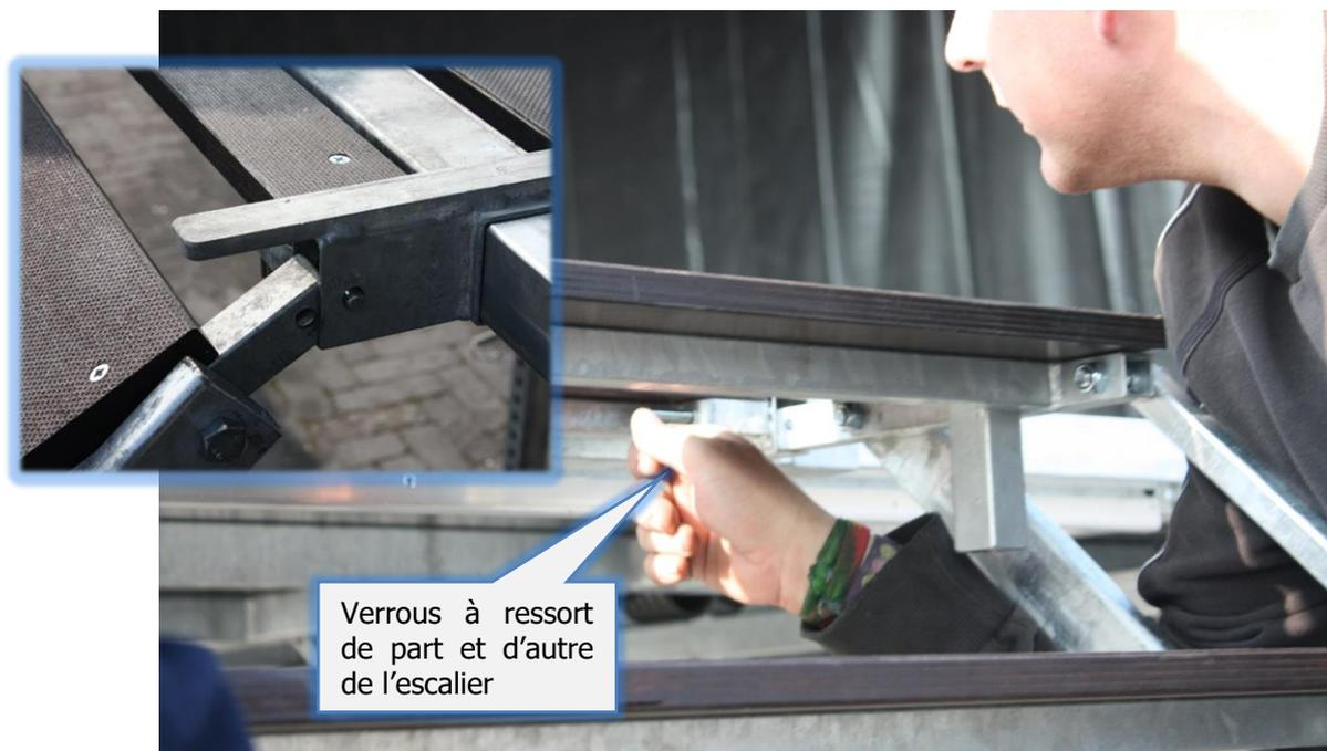
Immobiliser l'escalier à hauteur variable sur la barre de fixation au moyen de verrous à ressort prévus à cet effet.
