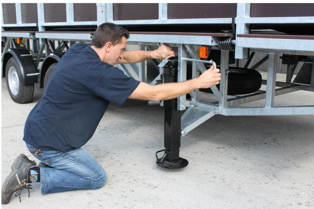
Pour immobiliser la béquille, engager la broche de verrouillage dans le fourreau prévu sur le dessus de celle-ci.
