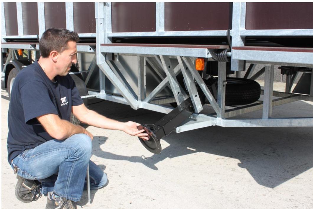
La béquille peut alors être lentement pivotée jusqu'à ce qu'elle atteigne sa position verticale. Durant ce mouvement, il y a lieu de veiller à maintenir la manivelle orientée vers le bas en parallèle avec la béquille.
